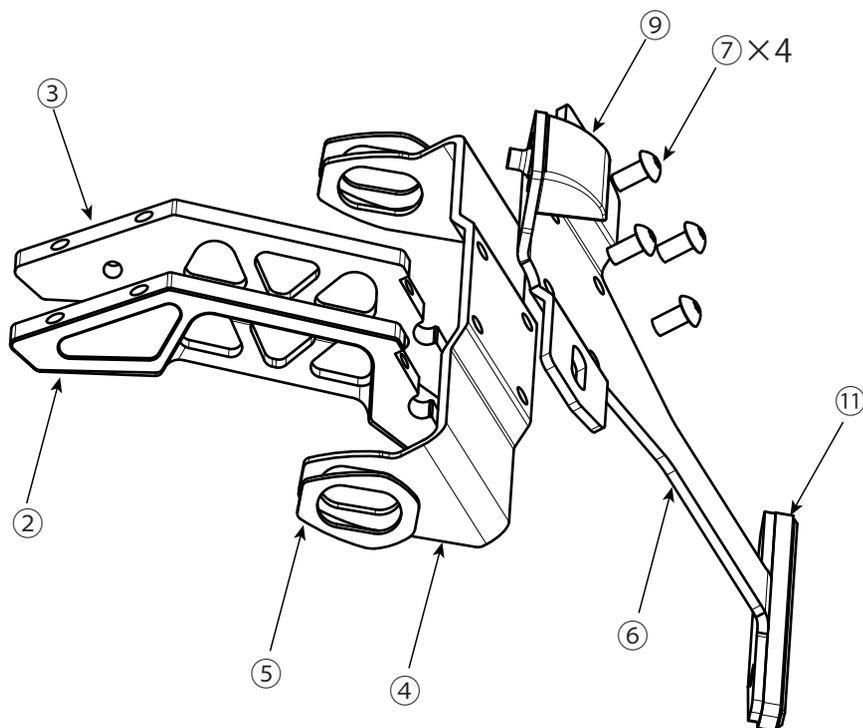
※②③の溝にウインカーの配線を通して組み立てます。配線を潰さないように注意してください。
