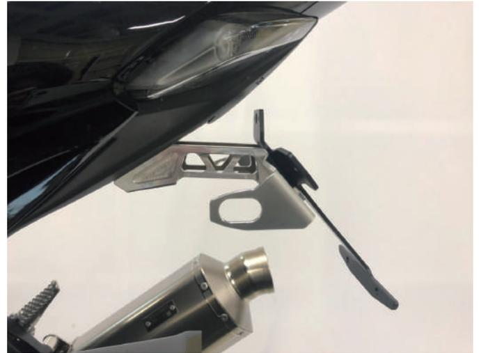
組み立てたパーツを車体に差し込むように取り付けます。
