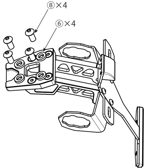
上図を参考に車体に配線を通し、⑥をフェンダーの取付部の溝に入るように設置し、付属のボルト⑧で製品を取り付けます。
