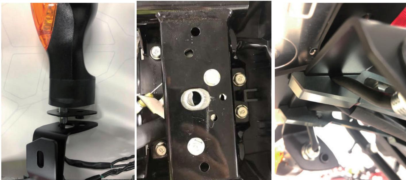
5. ①～⑤を組んだ状態で、純正フェンダーを固定していた4点の穴に①の突起部を合わせ、純正フェンダーを固定していたボルト4本で固定します。
