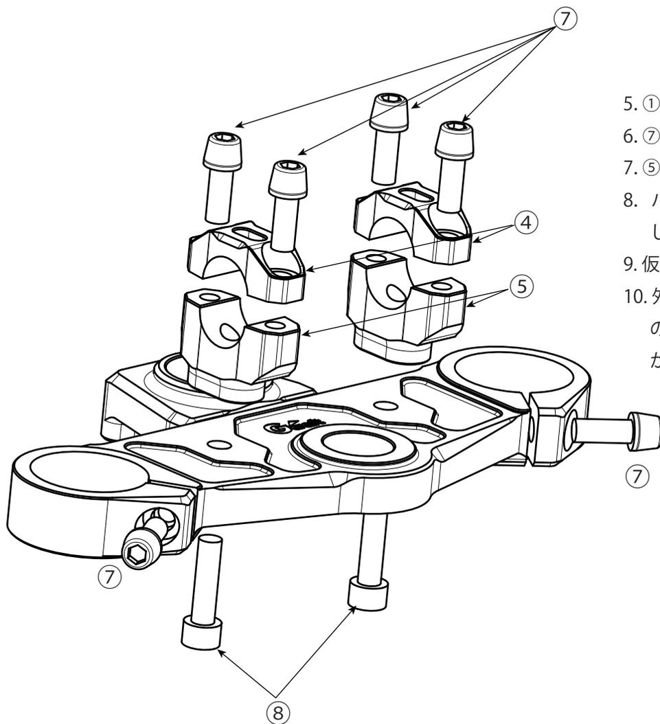
5. ①を純正ステムナットで固定します。
