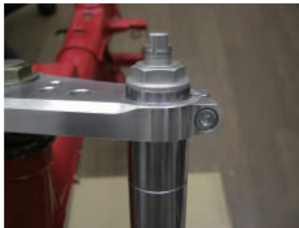
14. ステムを取付けたら分解図を参考に③④ハンドルクランプを⑦⑨ボルトを使用し固定してください。
