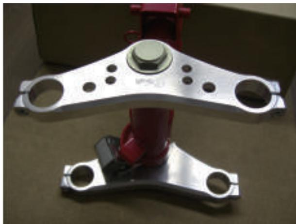
11. アンダーブラケット側で左右のフォークの高さを合わせ本締めしてください。
