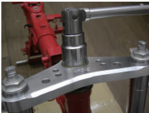
13. センターナット固定後、トップブリッジのフォーク固定ボルトを締めてください。
