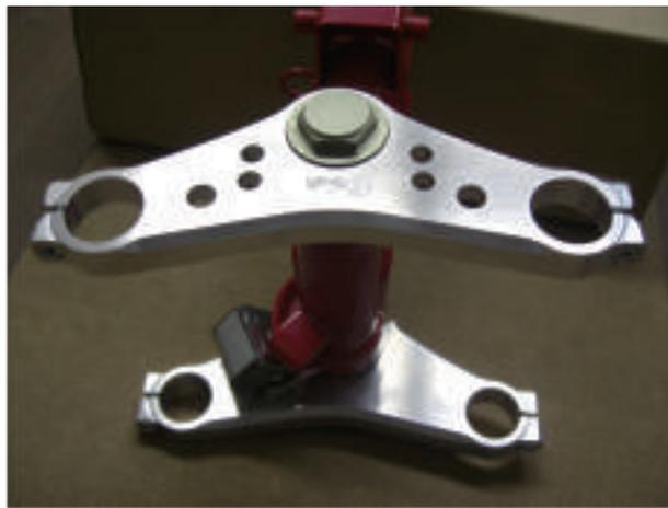
11. アンダーブラケット側で左右のフォークの高さを合わせ本締めしてください。
