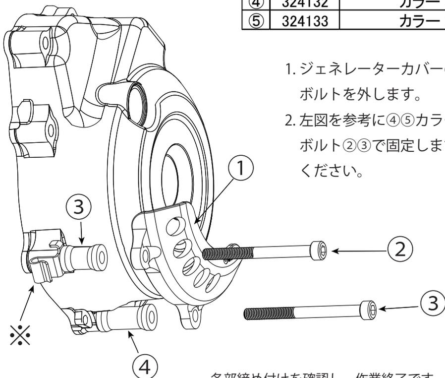
1. ジェネレーターカバーの左図③④部についている純正のボルトを外します。
