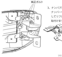
3、ナンバプレートと ナンバーベースを固定 してリフレクターを 貼付けます
