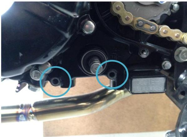
4. 図を参考に製品を取り付け、各所の増し締めをして完成です
