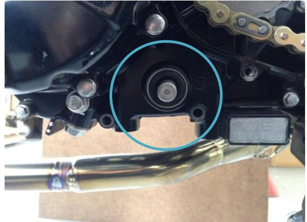
3. 下の2箇所のボルトを外します
