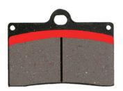
キャリパーとホイールのクリアランスの関係で 設計上、パッドが一部ローターと接触しません。 パッドの摩耗が進むとパッド同士が接触し、ロー ターを挟めずブレーキが効かなくなり非常に危 険ですので、上図の様に非接触部を削ってくだ さい。
