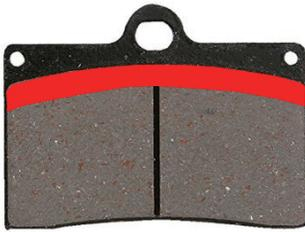
キャリパーとホイールのクリアランスの関係で設計上、パッドが一部ローターと接触しません。パッドの摩耗が進むとパッド同士が接触し、ローターを挟めずブレーキが効かなくなり非常に危険ですので、上図の様に非接触部を削ってください。
