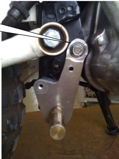
4. 300394 のステアにマスターを取り付けます。最初にマスターの表からM6-30 ボタンボルトを取り付け、
