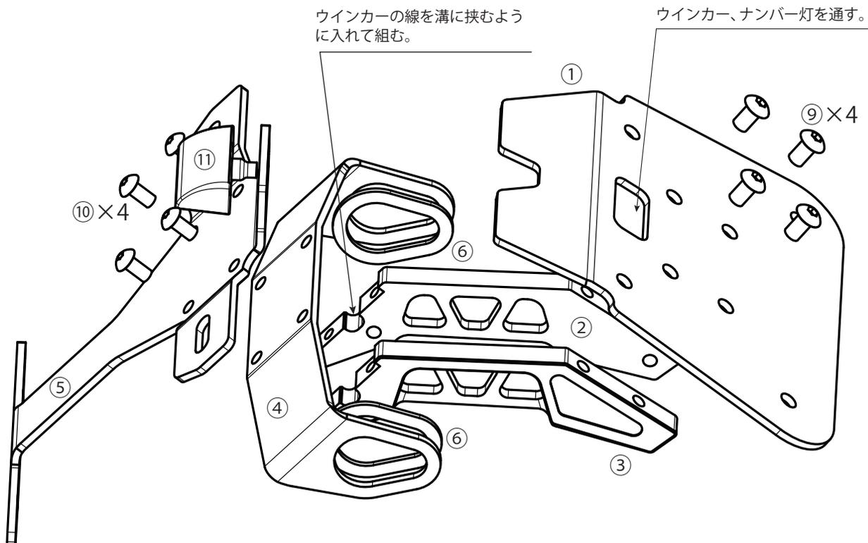
組んだキットを車体に取り付けます。(純正フェンダーを固定していたナットは再利用します。)
