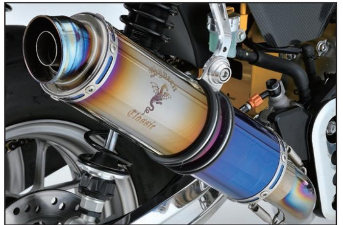
サイレンサーはクラス最小のパイプを使用。材質はオールチタンとし、車体の軽量化に貢献し、マフラー本体の美観にも貢献しています。拘りはマフラー本体だけでなく、削りだしのマフラステー、肉抜き加工されたサイレンサーバンド、美しい焼き色と一つ一つに拘りをもった究極の1品です。
