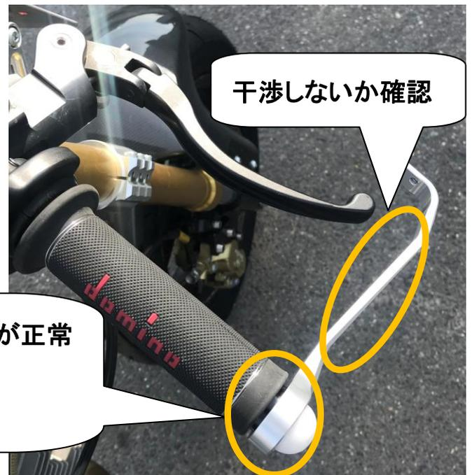
3mm 以上空け、組付け後にスロットルが正常に作動するか確認して下さい。
