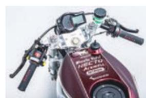
エースウェルの多機能デジタルメーター、ドミノ製グリップ、ゲイルスピード製ハイスクロなどで構成されたコックピット周り。
