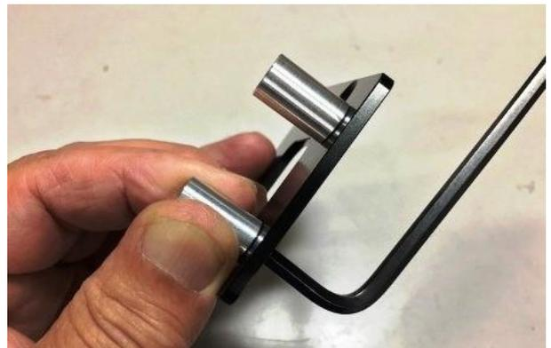
組みあがりましたらベースプレートに⑮のカラーを入れ、下図を参考にウインカー、ナンバー灯の配線をあらかじめ通しておき、純正フェンダーを取り付けていた穴4か所に差し込み⑩⑬のボルトで固定します。
