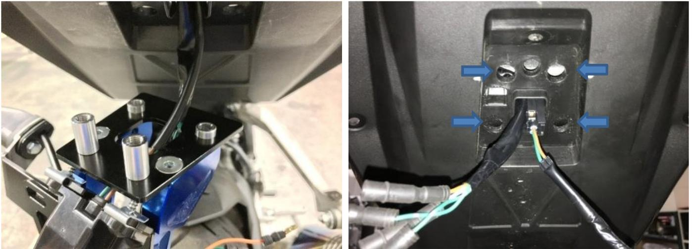
付属のエレクトロタップを使用し純正のナンバー灯の線から分岐させ⑧のナンバー灯を配線します。作業後ウインカー、ナンバー灯が点灯しているか確認してください。
