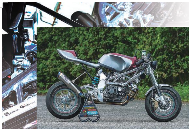
トラス形状のオリジナルアルミフレーム、NSR50用タンク(＋タンクカバー)、新デザインのアルミホイール(合わせタイプ)などの逸品が与えられ、既存のどのマシンにも似ていないフォルムを実現。
