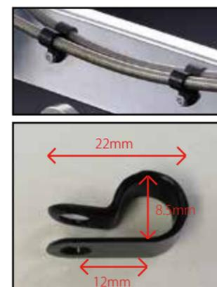
ブレーキホースクランプ加工（品番60194）をご利用頂きますと、ブレーキホースが綺麗に固定できるようになります。基本スイングアームパイプの裏側中心に、M4のナットを埋め込み、ホースバンドを取り付けております。取付位置の変更は可能ですが、トリプルスクエアパイプのみ、目の字断面構造になっておりますので、この付近にナットを埋め込むことはできません。クランプ位置変更の際は、ご注文時に当社までご連絡ください。
