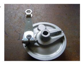
・写真のようにスペーサーを<u>ホイールの裏側(進行方向に対して左)</u>からはめて、M8-25 フランジキャップボルトと M8 フランジ付きナットで装着してください。
