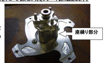
・純正ブレーキパネルに装着されているブレーキアームを専用ブレー キアーム(品番 32044)に変更します。
