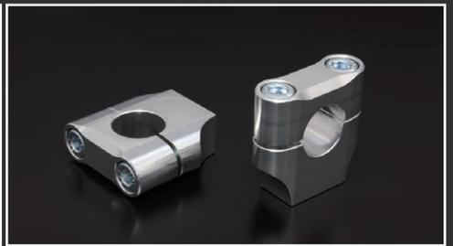
ステムキットと同じく、新形状のハンドルクランプが付属します。(31181、31182、31183) 固定ボルトをM6→M8に変更する事でハンドルをしっかりとクランプする事が可能で剛性アップに貢献しています。
