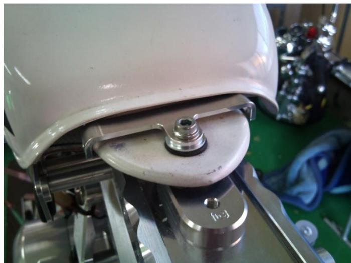
上記図のように専用のステーを使用してタンクを固定してください。
