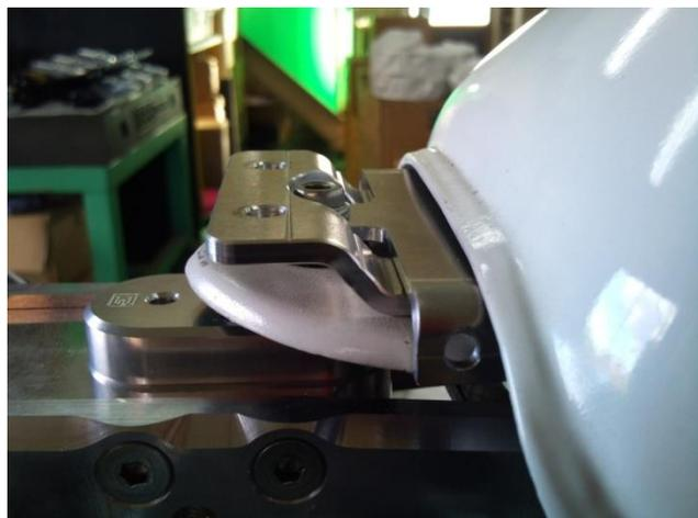
図のように専用ステーに差し込むようにシートを装着してください。
