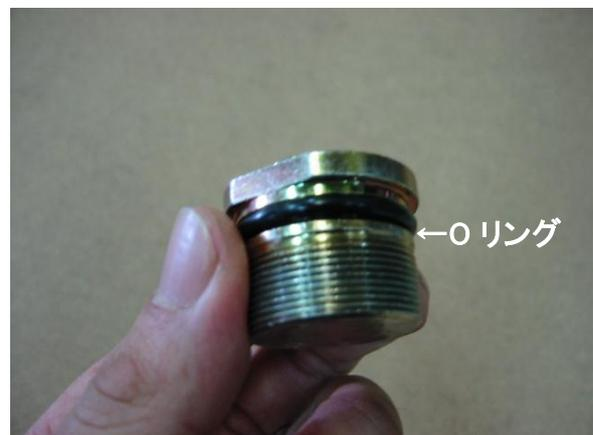
3. ノーマルフォークキャップのOリングを取り外し、延長キット本体に移植してください。(スムーズに組み込めるようOリングに少量のフォークOILを塗布してください)
