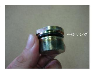
2 ノーマルフォークキャップの O リングを取り外し、延長 KIT 本体に移植してください。(スムーズに組み込めるよう O リングに少量のフォーク OIL を塗布してください)
