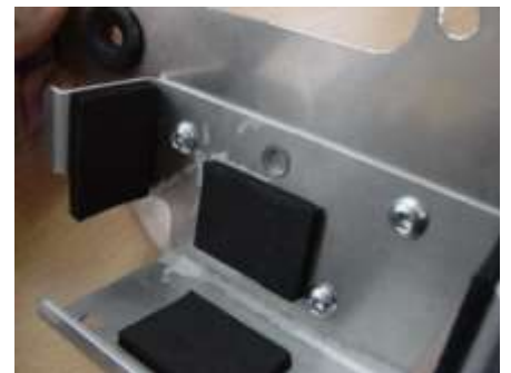
③バッテリーケースを取り付けます。M6×15のボタンボルト、フランジナットを使用します。
