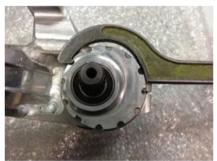
チェーンの調整はハブを固定している キャップボルト (65047) を2本緩め、引掛 ピンスパナ (70mm $\sim$ 75mm) を使用して 調節してください。
