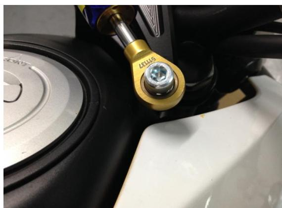
4.各ボルトの増し締めをし、ハンドルを左右に切って各部に干渉が無い事を確認します。
