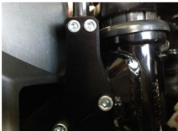
3.ハンドルストッパー側も組立図を参照し、取り付けます。必ずハンドルを右に切り、ステアリン
