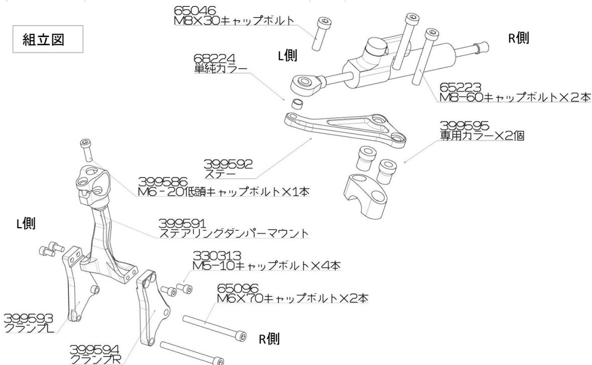
1.フレーム側から組立図を参照し取り付けます。
