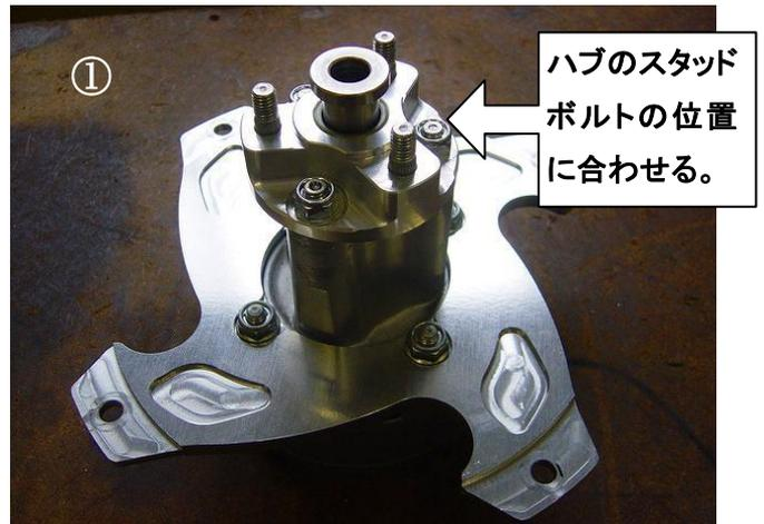
5. スプロケットをスペーサーに装着し、付属のロックナットで締めつけます。
