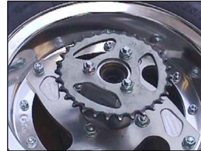
④スプロケットを付けます。付属の M8 ワッシャ、M8 ナットで固定してください。
