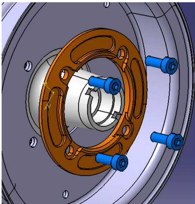
○純正ドラムハブと同時装着する場合はそのまま純正のナットで装着してください。
