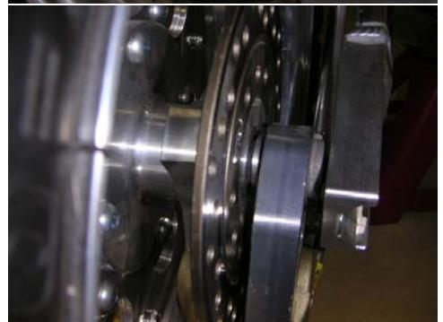
5. 走行前に全てのボルト類の締め付け確認をしてください。
