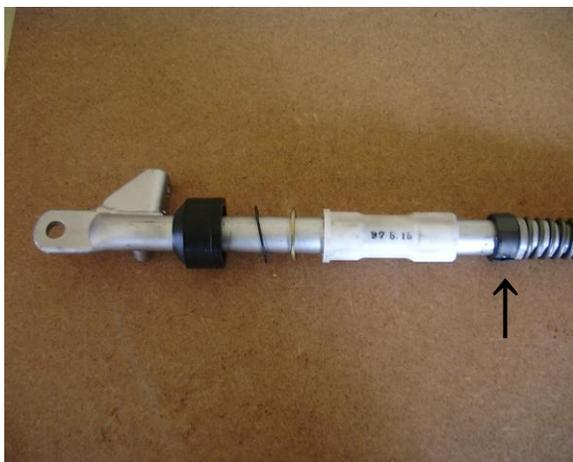
左図は右側フォークの組みあがり図です。スプリング部分のトップ(トップブリッジとの合わせ部分)部分も向きがあります。↑部分の樹脂製パーツも元どおり取付けます。
