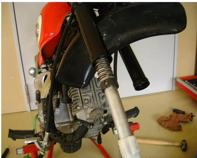
左右を確認してから、ノーマルの状態のように組立てていきます。一番奥まで差込んだら、トップブリッジ部分のボルトを締め付けます。必ずインナーチューブのトップ部分の凸部とトップブリッジ部分の凹部を合わせてからボルトを締めてください。
