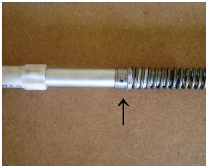
ノーマルインナーチューブから↑部分のピンを抜きます。(抜くにはハンマー等を使用していただいてもOKですが、ピンの他の部分をたたいて変形させないように注意して下さい) 抜けましたら、逆の順番で組み立ててください。向きに注意して作業して下さい。
