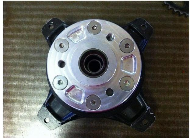
3. スペーサーをスペーサージョイントに取り付けていきます。スペーサージョイントの凸部と、スペーサーの凹が合うようにします。(矢印部分)
