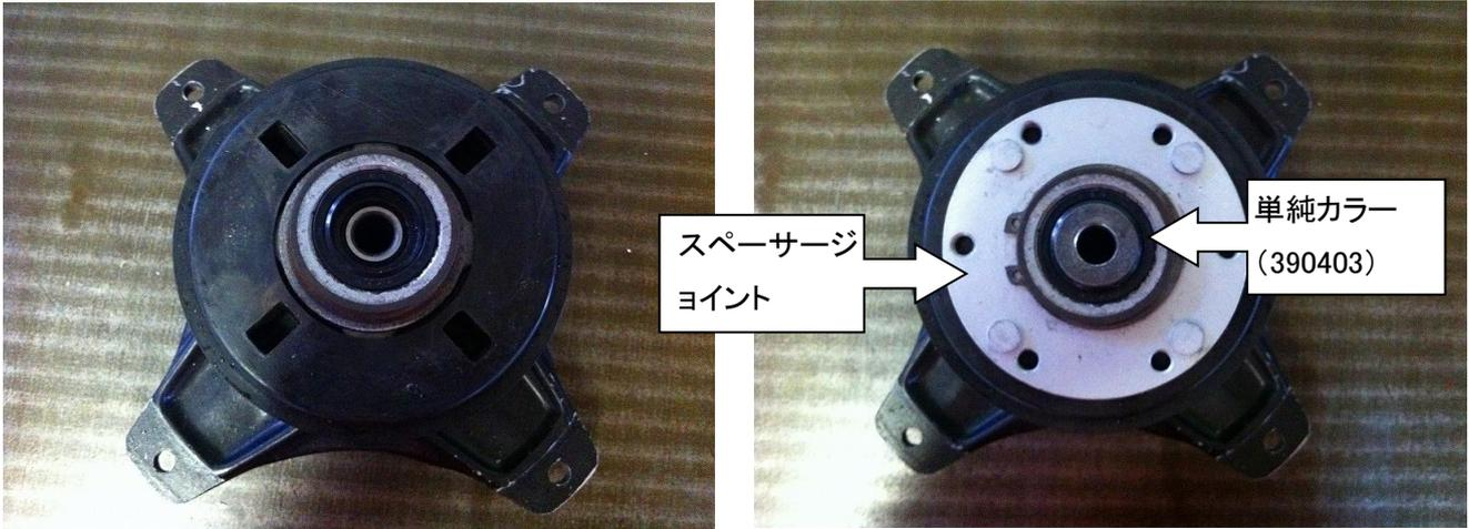
1. 純正ハブからスプロケットを外し、スペーサージョイントを純正スプロケットと同じ要領で純正部品のクリップを使って固定します。
