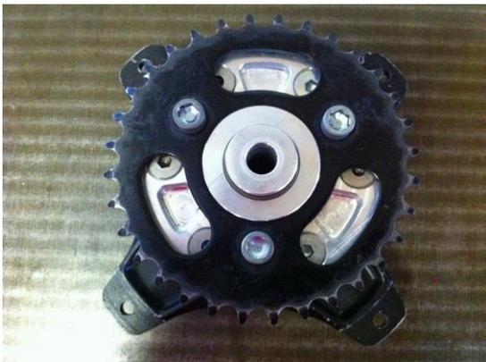
5. 付属の専用ボルトでスプロケットを固定します。
