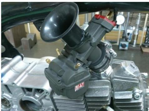
3. フューエルタンクを取り付けて、キャブレター本体、ファンネルがフレーム、タンクに干渉しない位置に調整して、キャブレター本体を固定してください。
