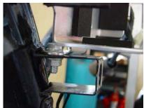
4. ウインカーリレーステーにウインカーリレー・CDI をそれぞれ固定します。なおレギュレーターはフレームに直接固定してください。
