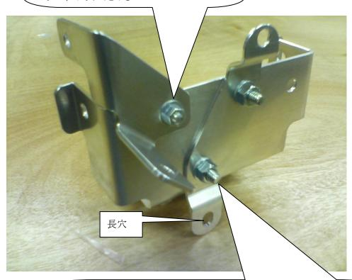
バッテリーケース固定用のステーをバッテリー側から M6 ボタンボルト、裏から、 M6 ワッシャ・ナットでとめる。
