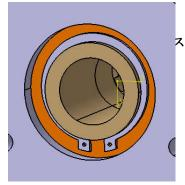
スプロケットカバー装着後、C型止め輪をスプロケットに装着してください。
