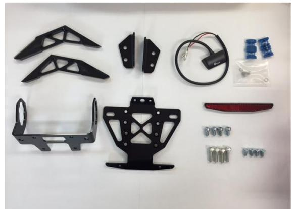
①連結プレートとベースプレートを付属ボルトで固定します。
