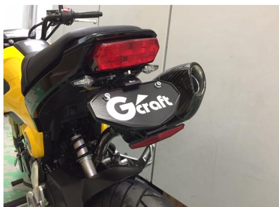
本商品は道路運送車両の保安基準(H27.6.15 現在)に則って各部反射器、方向指示器、ナンバープレートの角度、位置を最適にしております。
