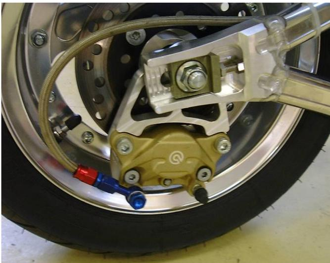
まずディスクローターとホイールの隙間からキャリパーを入れ、付属のボルトで固定します。キャリパーを固定してから先ほど仮止めしておいたディスクローターの固定ボルトを確実に固定します。チェーンの調製とアクスルシャフトの固定をしてからブレーキホースを取り付けます。エア抜き作業をして完成です。
