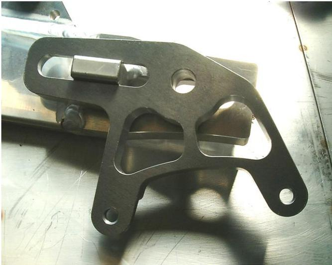
図のようにブレーキサポートを取り付けます。ブレーキ止めの部分に溝をはめ込み、アクスルシャフトの穴があっているか確認します。
