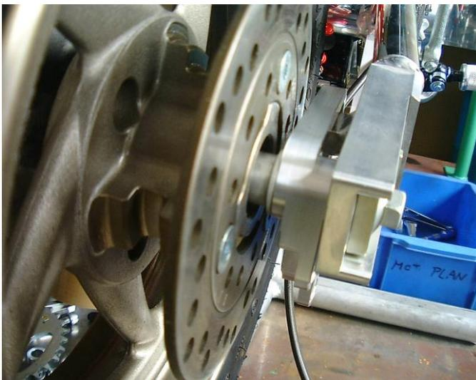
図のようにホイールを装着します。あとでキャリパーを取り付ける時に、ディスクローターを固定してしまうとキャリパーが入らないので、ディスクローターの固定ボルトは仮止めにしておきます。
