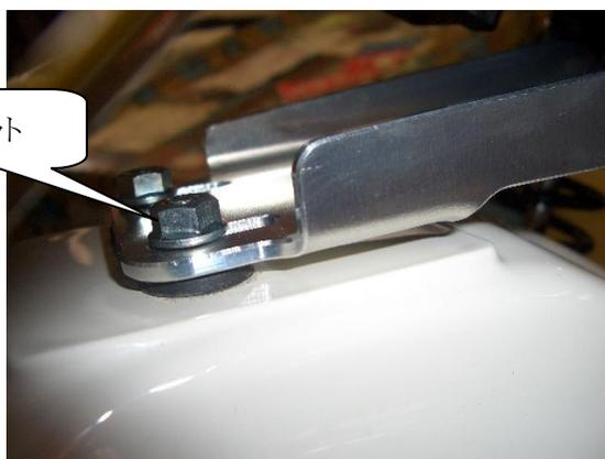
5. すべての部品を取り付け後、各部のボルトの増し締めと干渉のチェックを行ってください。干渉したままの走行は危険ですので絶対におやめください。
