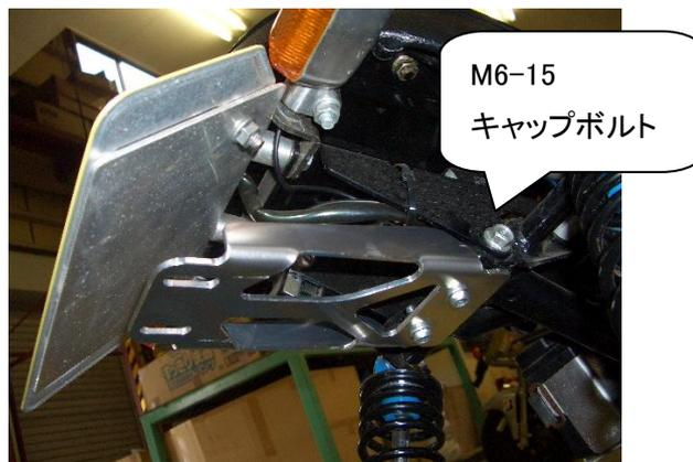
4. 純正段つきボルトを使用してフェンダーを固定します。
