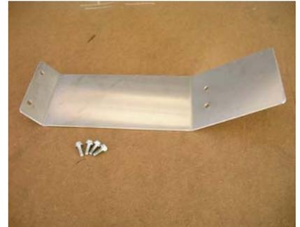
2, ペラフェンロングを車体に取り付けます。穴ピッチが広いほうを車体前部、狭いほうを車体後部に、M6 フランジ付キャップボルトで取り付けてください。
