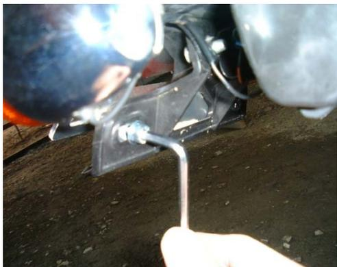
左図のようにナンバープレートステーを、車体側のナンバープレート取付け部分裏側から、キャップボルトにワッシャをはさんでから固定します。
