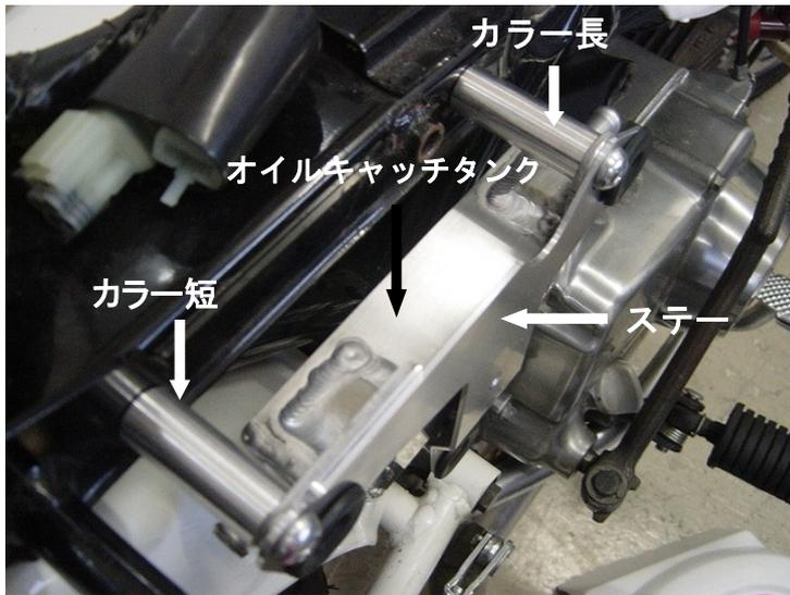
オイルキャッチタンクのステーを、カラーと取り付けステー本体の間にかませ、ボタンプルトと一緒に固定します。
