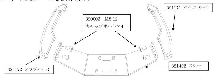
3. 下図の順番で、純正フェンダーを取り付けていた4箇所の穴を使い固定します。
