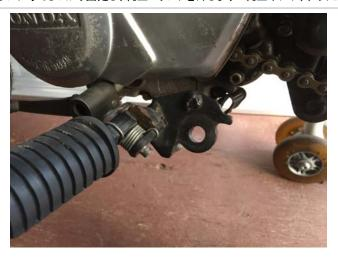
2.本商品を取り付け、スプリングをかけたら完成です 組み付け後の増し締めと走行後の確認を必ず行ってください
