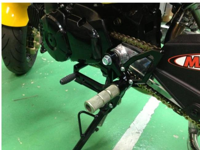
7. ブレーキペダル、BSプレートの裏面にブレーキスイッチステーを取り付けます。
