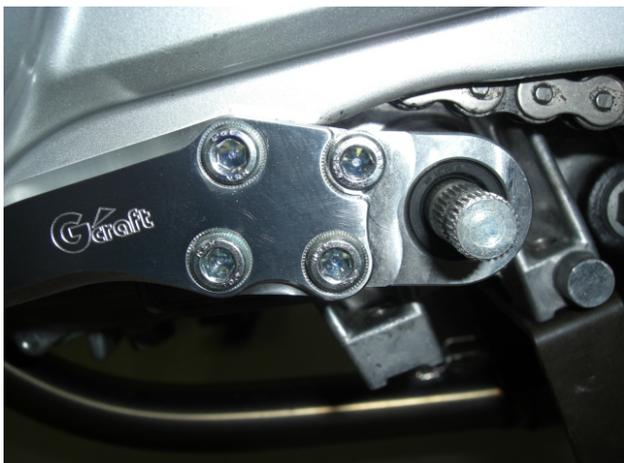
シフトガイドの位置を調整し、全てのボルトを本締めして下さい。
