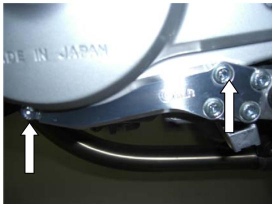
矢印の位置の純正ボルトを外して下さい。
