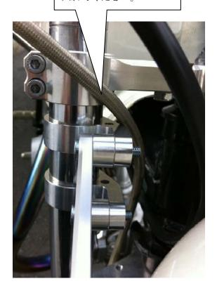
4.ライトステーの高さを調整してヘッドライトを取付けます。付属のボタンボルトを使用します。 (ノーマルヘッドライト以外でボルトの長さが足りない時は、お客様の方でお買い求めください。) ウインカーステーも一緒に取付けてください。ウインカーは純正ボルトを使用してください。
