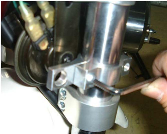
ウィンカーステーの長い方を内側にして、外側から短い方のステーを合わせてボタンボルトで固定します。まず前になるほうを固定しますが、短い方のステーはボルト穴部分の幅に違いがありまして、横からみて幅のあるほうを前にして下さい。ボタンボルトは前側のみまず固定します。左右共通の作業です。
