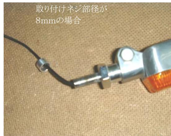
ウィンカーの取り付けネジ部の径が8mmの場合は付属のカラーをウィンカーのコードに通します。(10mmの場合は必要ありません)ウィンカーステーの長い方の取り付け穴に、ウィンカーのコードを通してから、ウィンカーに付属のナットで固定します
